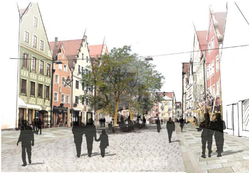
Ein insgesamt bodenbündiges Belagsmuster spannt sich zwischen den Fassaden auf. Die zwei Belagsarten sorgen für eine intuitive Trennung der Geschwindigkeiten. Der mittlere Bereich ist befahrbar. Die seitlich angeordneten Ruhe- und Spielpunkte erhalten einen größeren langsamen Belag.
