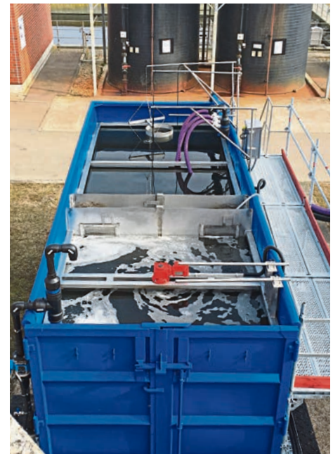
Pilotanlage der nachgeschalteten Denitrifikationsstufe während der Testphase
