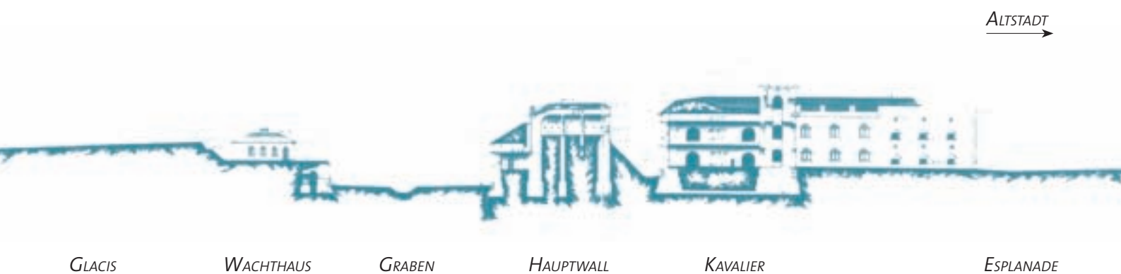
SNITT DURCH DIE POLYGONALEN FESTUNGSANLAGEN IM BEREICH DER REGELMÄSSIGEN FRONTEN
